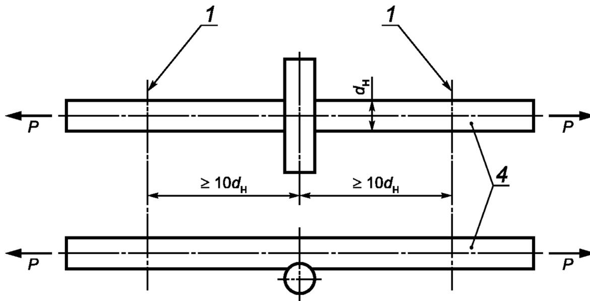
$d_n$  — номинальный диаметр рабочей арматуры;  $P$  — испытательная нагрузка;
