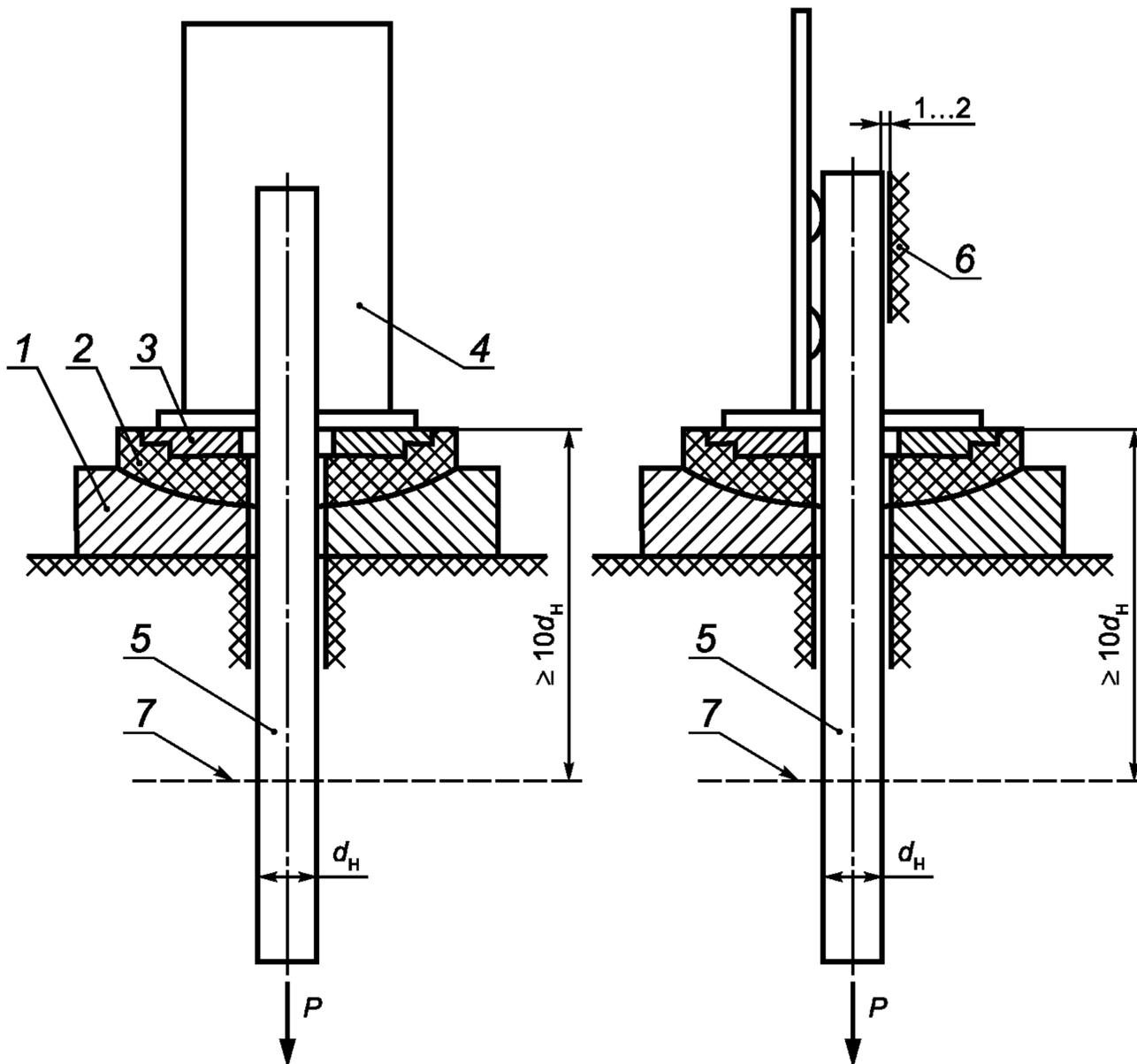
$d_H$  — номинальный диаметр анкерного стержня;  $P$  — испытательная нагрузка; 1 — сферическая опора; 2 — сферический вкладыш; 3 — сменное опорное кольцо; 4 — плоский элемент закладного изделия; 5 — анкерный стержень; 6 — упор, препятствующий изгибу образца; 7 — граница закрепления в захватах разрывной машины
