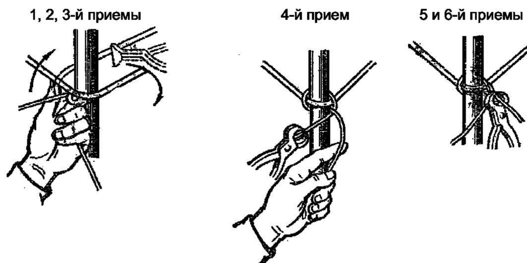
б) Вязка угловых узлов
