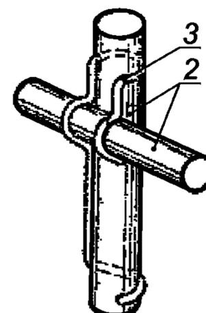
е) Скрепление стержней соединительными элементами
