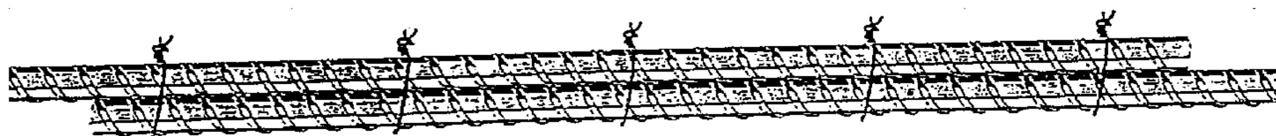
Рисунок Ж.1 — Соединение стержней продольной арматуры внахлестку
