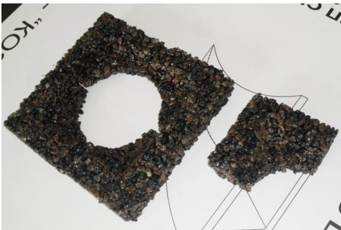
Схема 3 Дренажные брикеты «Козинаки ® » – трубка
